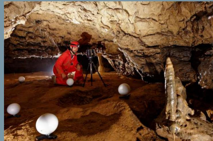
↑ Relevé 3D par lasergrammétrie dans une grotte des Gorges de l'Ardèche (France). L'appareil, placé en plusieurs positions, relève un nuage de points à très haute densité et sans contact avec la paroi. Les sphères blanches servent à l'assemblage des différents relevés.
